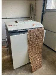
Abbildung 69: Verpackungspolstermaschine Karton
