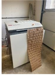
Abbildung 69: Verpackungspolstermaschine Karton
