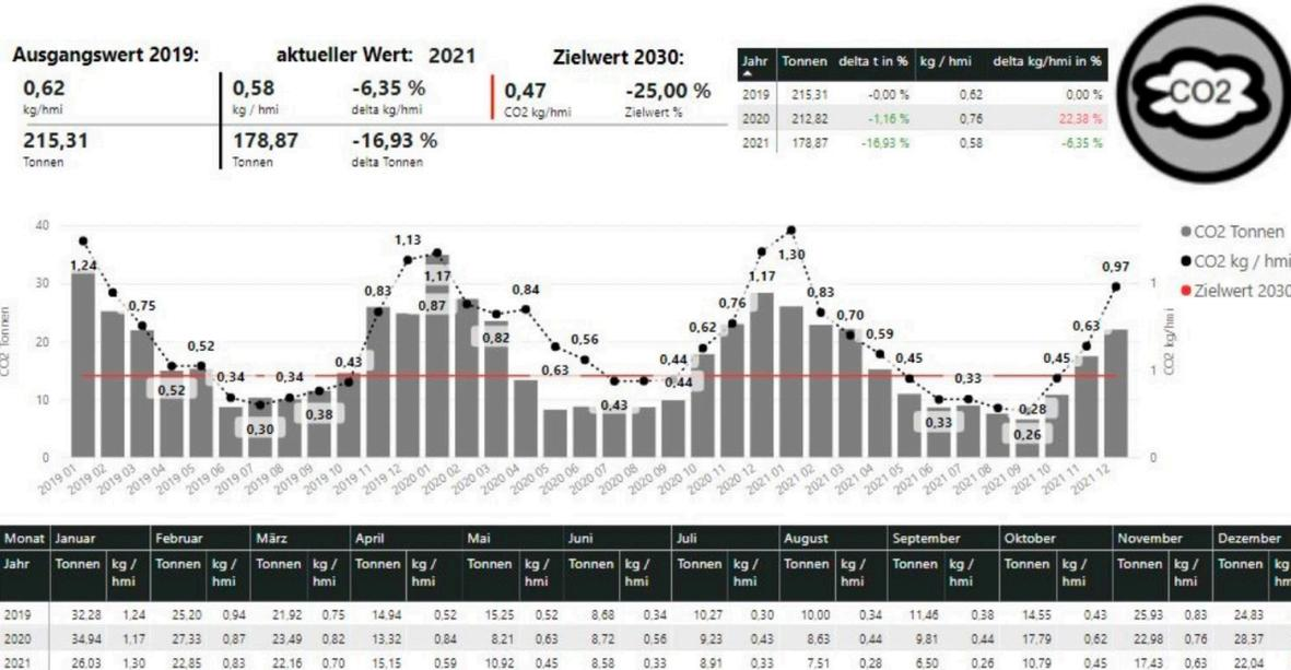
Durch Maßnahmen, wie die Erneuerung der Heizungssteuerung in der Fertigungsstätte wurde 2021 eine absolute Reduktion von 17% im Vergleich zu 2019 erreicht. Das wirkt sich auch auf die relative Kennzahl kg CO<sub>2</sub>/hmi positiv aus. Der Anstieg (kg CO<sub>2</sub>/hmi) im Jahr 2020 ist auf die Kurzarbeit zurückzuführen. In den nächsten Jahren sind weitere Optimierungen in der Heizanlage geplant, um das Ziel zeitnah zu erreichen.
