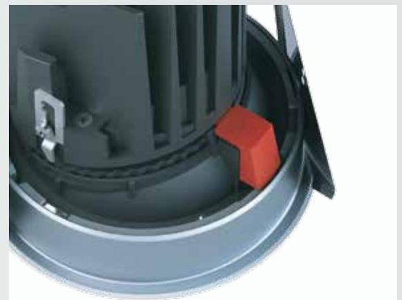
Die Schraube wird von unten gedreht und zieht so die rote Befestigungsklammer zu.
