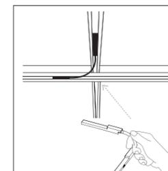
**ELECTRICAL CONNECTION** Jedem T-Verbinder liegt ein und jedem X-Verbinder zwei flexible Kreuzadapter bei. Eine elektrische Verbindung der einzelnen Schienen-Elemente kann mit diesen Komponenten unkompliziert hergestellt werden.
