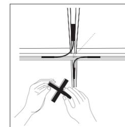
**COVERING THE CROSSINGS** Die Abdeckungen, als farbiger Akzent in einer der PROLICHT-Farben oder abgestimmt auf die Farbe der Schiene, werden als letzter Schritt angebracht.
