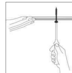
**TRACK MOUNTING** Die Schiene ist so konzipiert, dass sie vor Ort leicht zugeschnitten und direkt an die Decke geschraubt werden kann, um bei jeder Installation ein maßgeschneidertes Ergebnis zu erzielen. Die Artikelnummer für ein Schraubenset (50 Stück) lautet: 800-1427
