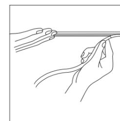
**TRACKMASK** Eine schwarze flexible Gummiabdeckung, die nach dem Positionieren der Einsätze direkt vor Ort zugeschnitten und in die Schiene integriert werden kann, gibt der minimalistischen Erscheinung des MINIMAL TRACK den letzten Schliff.
